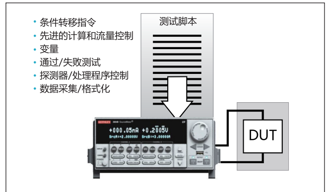
TSP 技术从 2601B-PULSE 非易失性内存执行完整的测试程序
